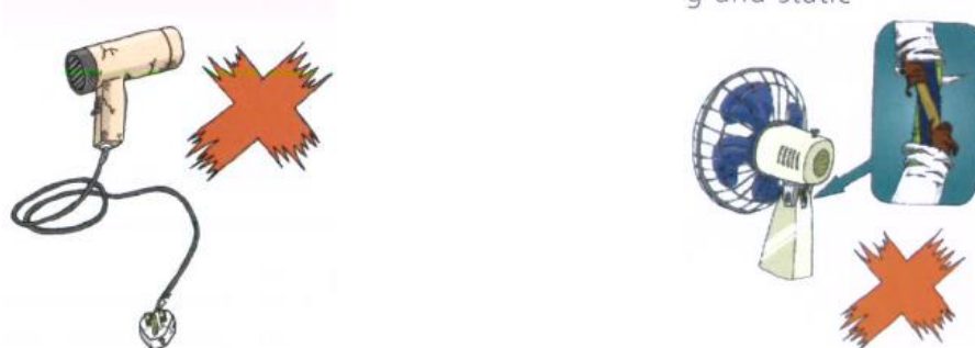
Hình 2.3: Thiết bị không còn tính năng an toàn
